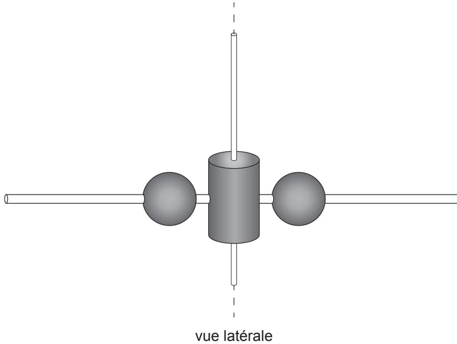
Une force horizontale de 50 N est appliquée perpendiculairement à la tige à une distance de 0,50 m de l'axe central. Une autre force horizontale de 40 N est appliquée dans la direction opposée à une distance de 0,20 m de l'axe central. La résistance de l'air est négligeable.
