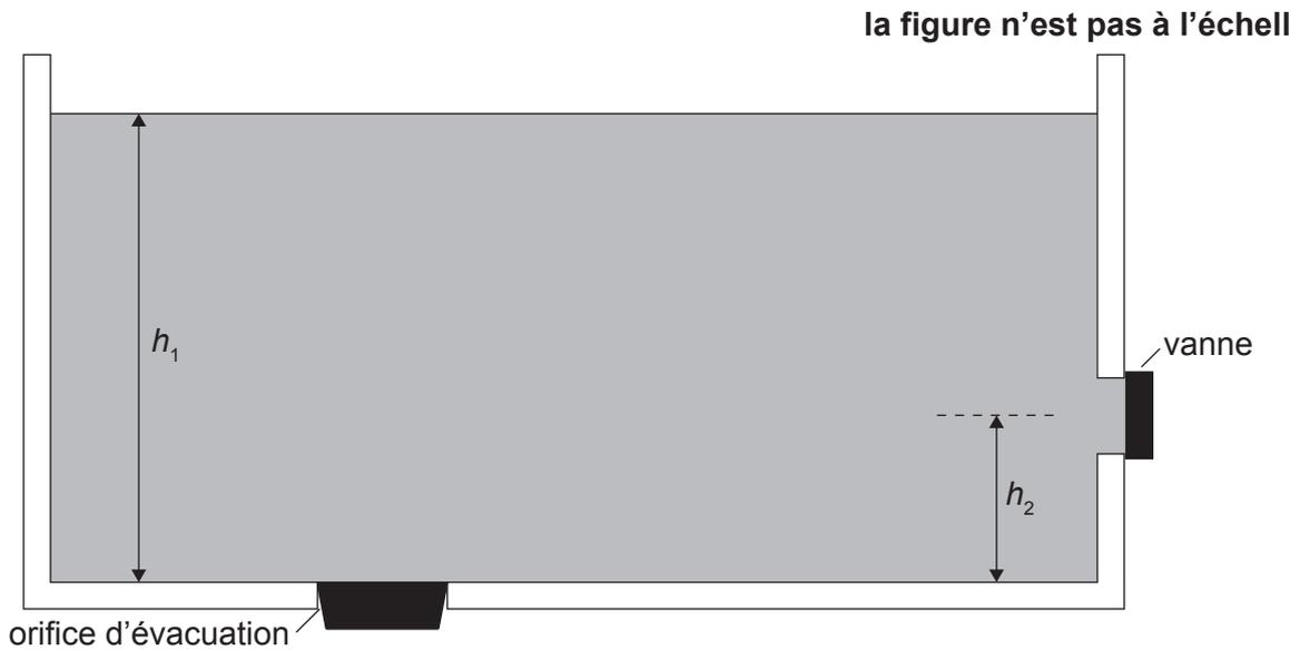
L'orifice d'évacuation a un diamètre de 100 mm et un obturateur métallique d'une masse de 2,5 kg est utilisé pour obturer l'orifice d'évacuation.
